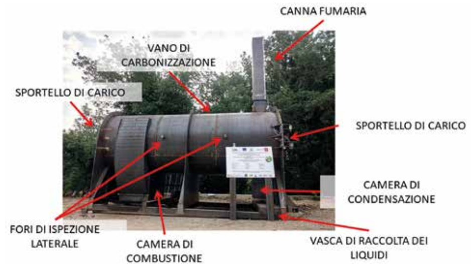
Figura 2 - Dettaglio delle varie componenti della nuova carbonaia.
