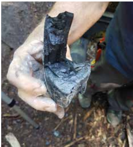
Figura 3 - Dettaglio del carbone ottenuto con il nuovo prototipo di forno mobile.
